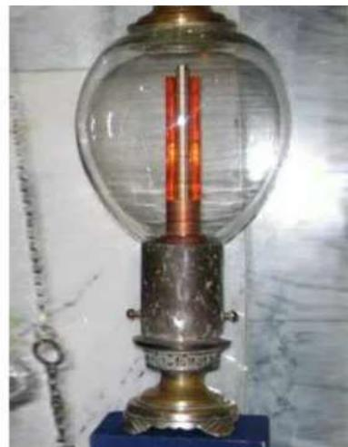
**Лампа на основе свечения электрической дуги**
